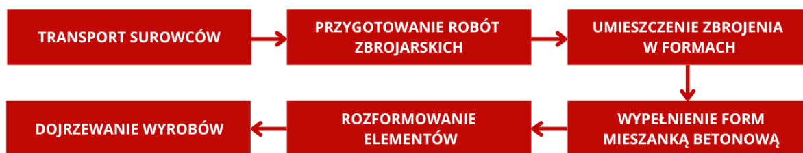
Rysunek 5.2 : Schemat procesu produkcji prefabrykatów dla budownictwa kolejowego
